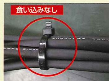
IV電線 8mm 2 60A通電 EM-LMFC 5.5mm 2 60A通電
