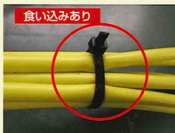
IV電線 8mm 2 60A通電 EM-LMFC 5.5mm 2 60A通電
